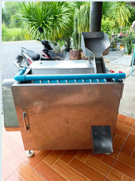
ภาพที่ 3.1 เครื่องปอกไข่นกกกระทาสำหรับกลุ่มวิสาหกิจชุมชนขนาดเล็ก ที่มา : (จรัญ ธรรมใจ และคณะ, 2564)
