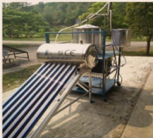
ภาพที่ 4.18 เครื่องนึ่งและอบข้าวฮางอกด้วยอินฟราเรดร่วมกับพลังงานแสงอาทิตย์
